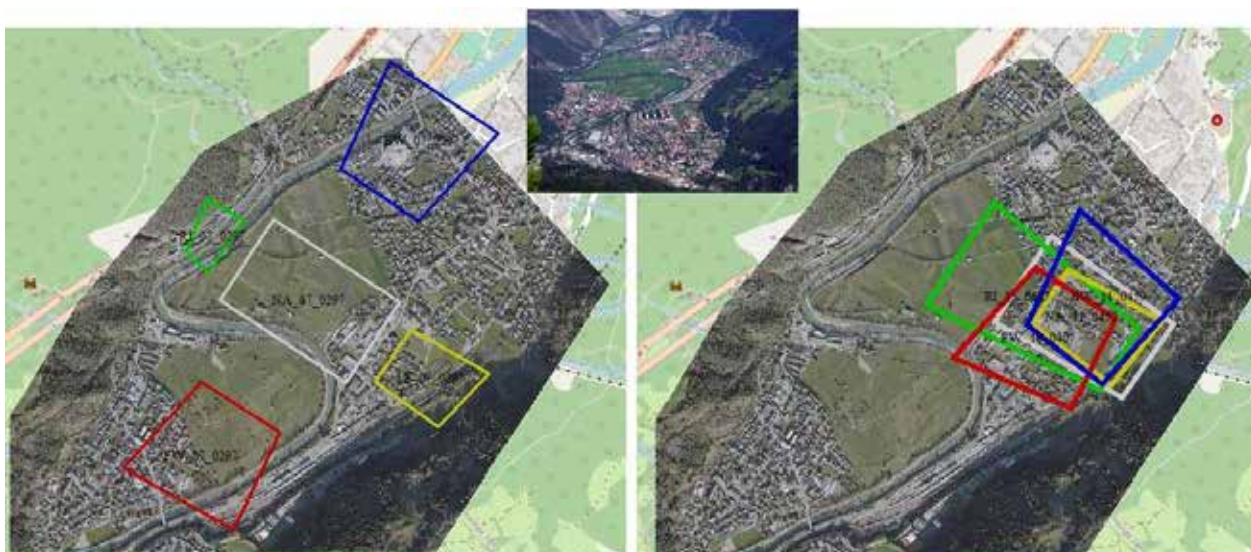
Abb. 3: Footprints einer Malteserkreuz-Kamera im Bergland (Zams, Tirol, 2019). Links = alle fünf Bilder eines Auslösepunkts, Rechts = Bilder aller fünf Kameras an einem Ort (verschiedene Auslösepunkte).
