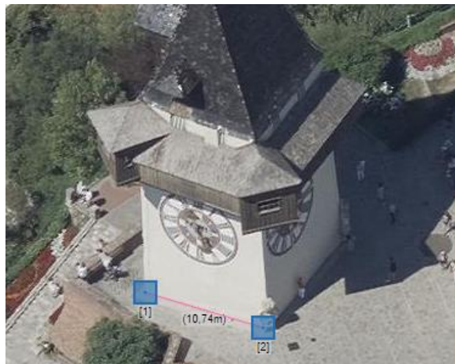
Abb. 17: Die Streckenlänge zwischen Punkt [1] und Punkt [2] wird automatisch ermittelt und sofort angezeigt
