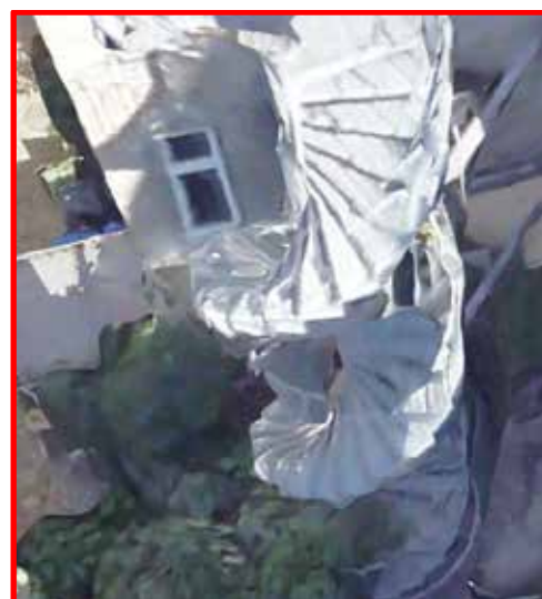
Abb. 6: Probleme im 3D-Mesh von Kopenhagen 2021 werden in (zu) hohen Zoomstufen sichtbar (rechts)
