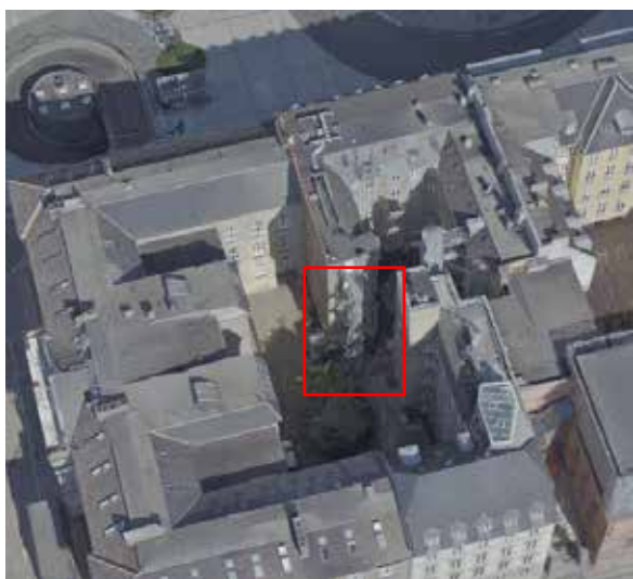
Abb. 6: Probleme im 3D-Mesh von Kopenhagen 2021 werden in (zu) hohen Zoomstufen sichtbar (rechts)
